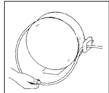
**Achtung** Nach dem Erhöhen der Federkraft muß überprüft werden, ob der Schlauch ganz abgerollt werden kann, ohne daß dabei die Feder völlig zum Anschlag kommt und somit überspannt ist.
